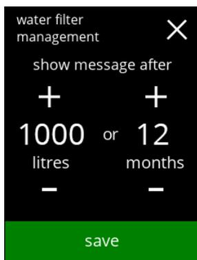
Die Meldung ‚Wasserfilter ersetzen‘ einstellen:
