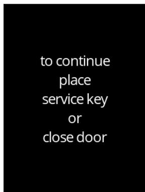
Wenn die Tür geöffnet wird, wird der Sicherheitsschalter aktiviert und eine Meldung angezeigt.
