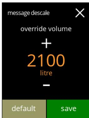
Das maximale Standardvolumen erhöhen:
