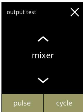
Test der Mischermotoren:
