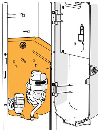
► *Um ein Verstopfen der in das Mischsystem gefallenen Zutaten zu verhindern, wird empfohlen, die Maschine nach der täglichen Reinigung zu spülen, siehe §5.1.1 auf S.15.*
