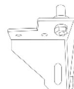
9. Wyjąć sworzeń zawiasu dolnego i obrócić zawias dolny o 90 stopni.
