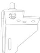
10. Den Stift vom unteren Scharnier wieder auf dem gedrehten Scharnier montieren.
