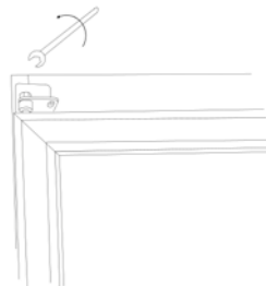
8. Den Stift vom oberen Scharnier spannen.
