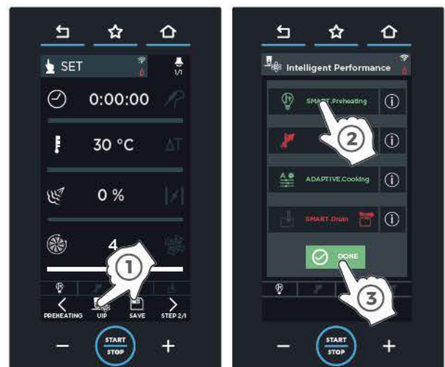
Vorheizen mit SMART.Preheating
