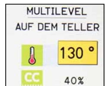
Anschließend die Zeile des Multilevels "TELLER" auswählen.
