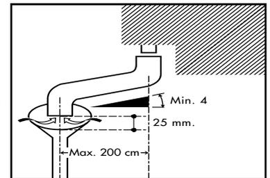
**ACHTUNG!** - Der Wasserauslass muss in jeden Fall außerhalb des Geräts angebracht werden. Es ist unbedingt notwendig, einen großen Sammelbehälter aufzustellen (siehe Zeichnung), um einen freien Abfluss zu garantieren. ES IST ABSOLUT VERBOTEN, DEN DURCHMESSER DES ABFLUSSES ZU SENKEN.
