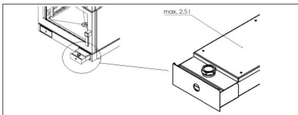
Wassermangel im Wassertank wird direkt auf der elektronischen Platine angezeigt. Der Wassertank befindet sich auf der vorderen Seite, unten rechts. Zum Auffüllen den Wassertank 10 cm herausziehen und den Verschluss herausdrehen. Den Wassertank mit enthärtetem Wasser auffüllen (max. 2.5 Lt). Den Verschluss zumachen und den Wassertank wieder in seinen Raum stellen.
