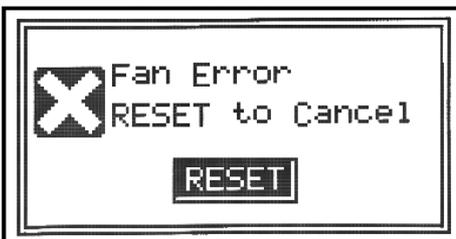
Der Ofen ist mit einem Sicherheitssensor ausgestattet, der die Rotation des Lüfters steuert. Die angesaugte Luft ist für den Ofen essentiell, um korrekt zu arbeiten. Wenn diese Fehleranzeige angezeigt wird, blockiert das System den Gasbetrieb. Überprüfen Sie den Lüftermotor.
