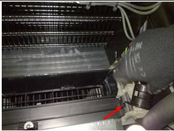
10. Die Spachtelmasse für die Versiegelung entfernen, um den Fühler zu ermitteln.
