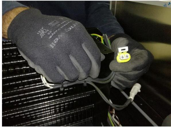
**14.** Die beiden Endstücke des Steckverbinders schließen.
