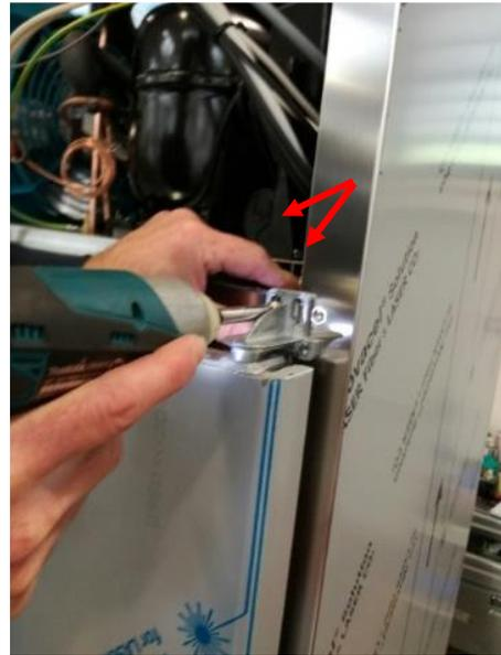
3. Die Tür entfernen und diese dazu vom unteren Scharnier anheben. Die beiden Schrauben für die Schließhalterung an der oberen Seite der Tür lösen.
