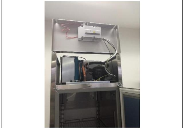
3. Die Verteilerdose entfernen und dazu die beiden Verschlusschrauben lösen.
