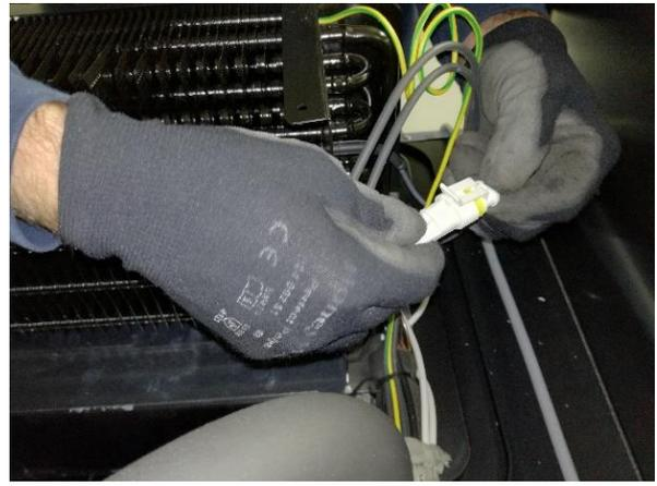
**11.** Die Heizung auswechseln, dazu die Kabel in die entsprechenden Bohrungen an der Seite des Verdampfers einführen.
