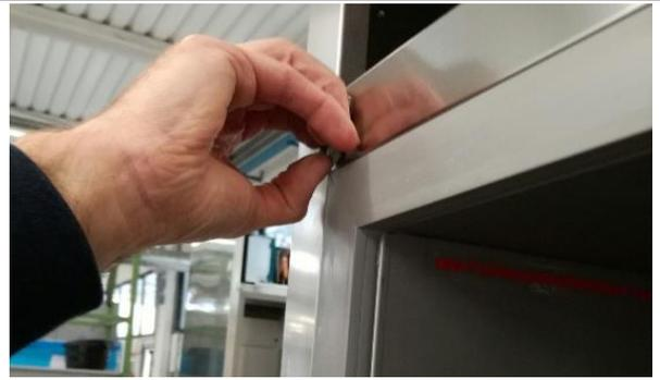
9. Die zwei unteren Bohrungen an der rechten Seite des Chassis mit den gerade entfernten Verschlüssen schließen.
