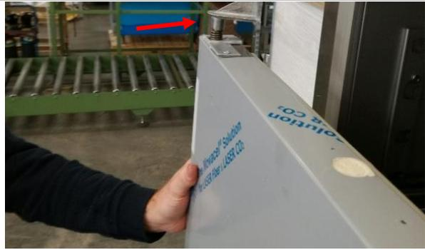
8. Die unteren Kunststoffverschlüsse von der oberen linken Seite des Chassis entfernen.
