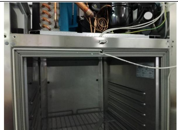
7. Die Klemme trennen, die der Heizung entspricht (siehe elektrischen Schaltplan).
