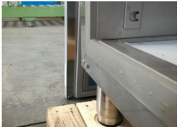
12. Die zwei unteren Bohrungen an der rechten Seite des Chassis mit den gerade entfernten Verschlüssen schließen.
