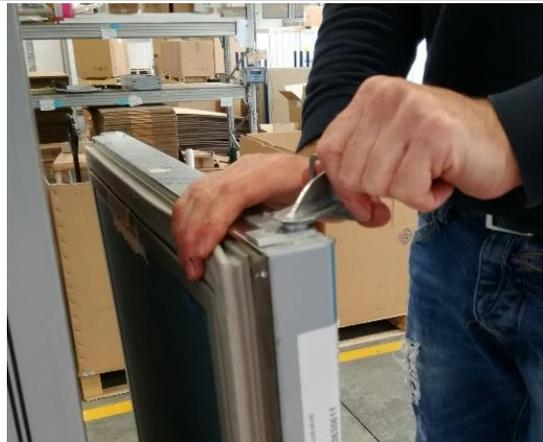
15. Das obere Scharnier am Chassis befestigen.
