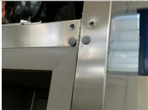
10. Die zwei Schrauben zur Befestigung des unteren Scharniers lösen.
