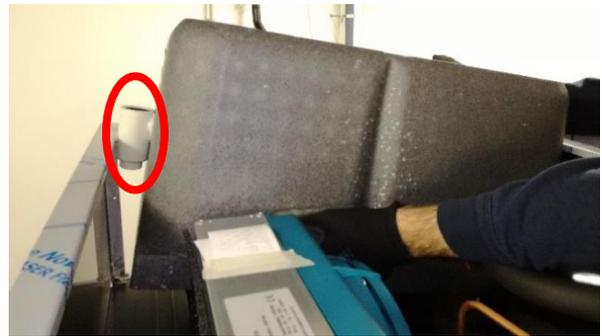
9. Den Kunststoffschutz der Kabel entfernen.
