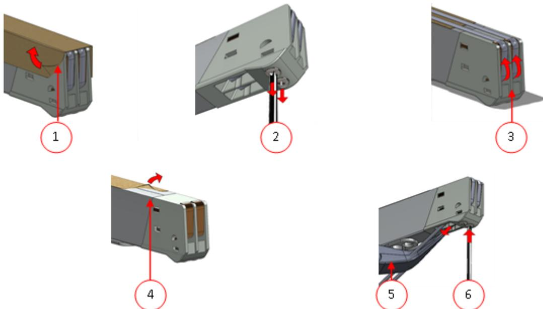
*Abbildung 15: Austausch des Schweißdrahts*
