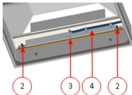
Abbildung 14: Schweißleiste entfernen
