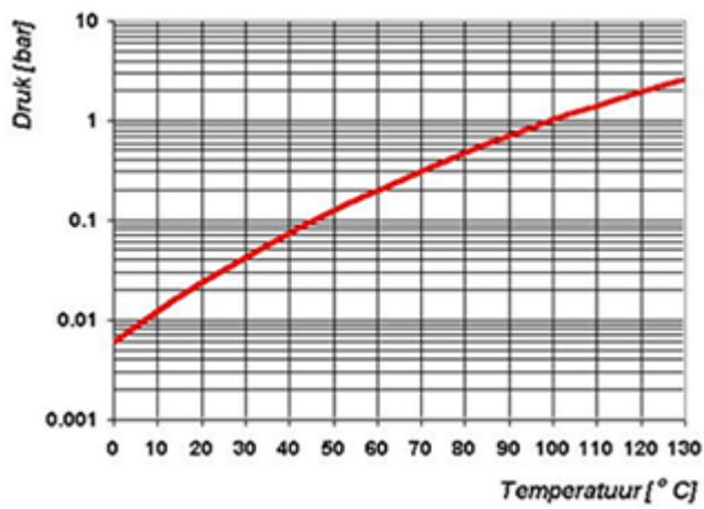
Abbildung 21: Dampfdruckkurve von Wasser
