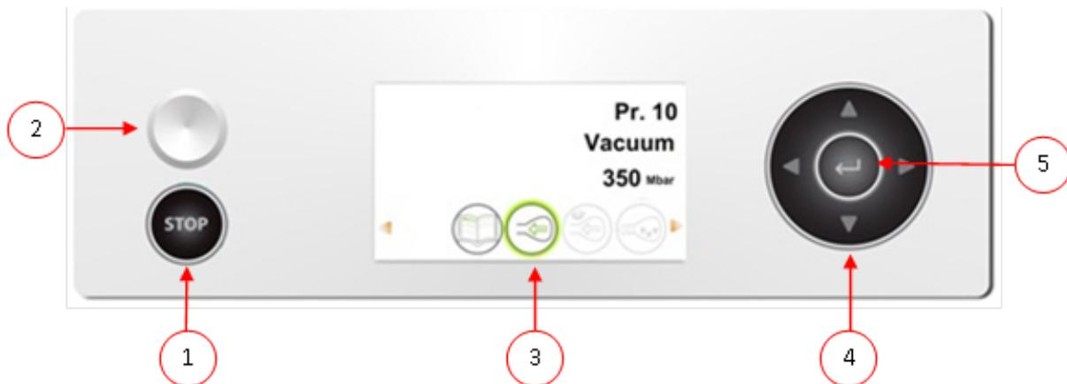
Abbildung 5: Bedienfeld des ACS (Advanced Control System)
