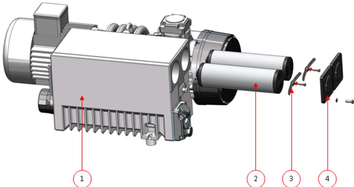
Abbildung 19: Austausch des Ölnebefilters
