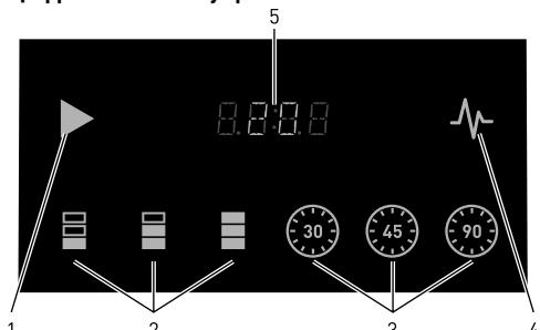
1. Выключатель ► [ВКЛ/ РЕЖИМ ОЖИДАНИЯ]: Нажмите для включения устройства. Нажмите еще раз для перевода устройства в режим ожидания.
