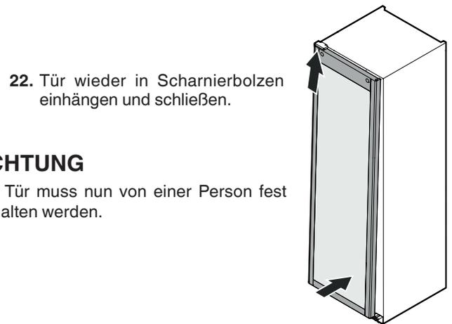
22. Tür wieder in Scharnierbolzen einhängen und schließen.
