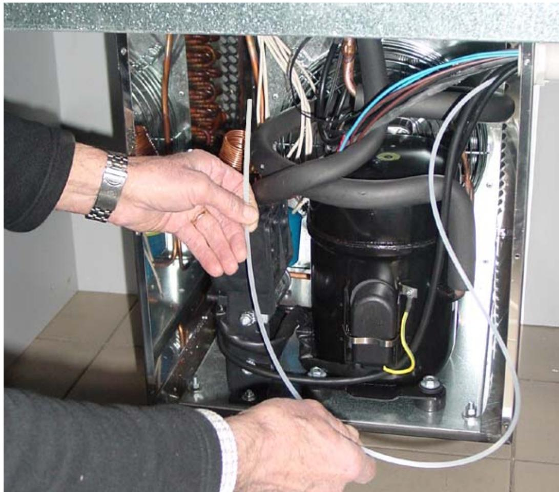
Die kabel tritt aus dem großen Loch aus, das zuvor in Seite A gebohrt worden ist.
