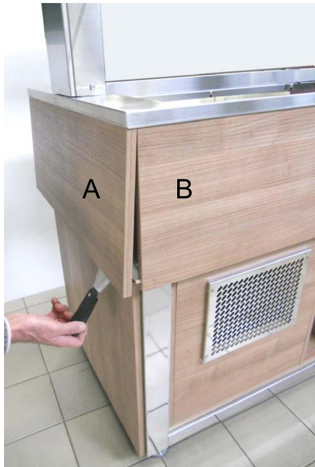
Gebruik een spatel om de eerste twee panelen open op de korte zijde A en open die op de lange zijde B.
