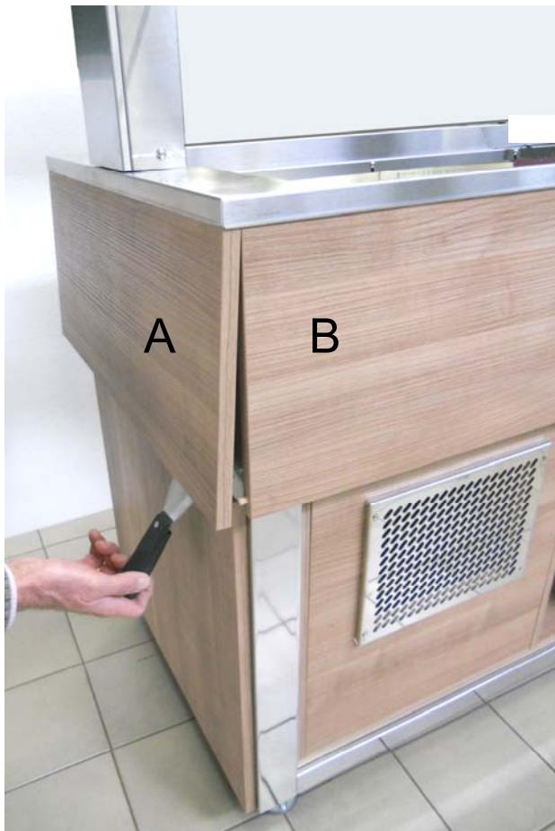
Öffnen Sie mit einem Spatel vor 2 Seitenwände und anschließend Öffnen kurzen Seite diejenigen entlang B.
