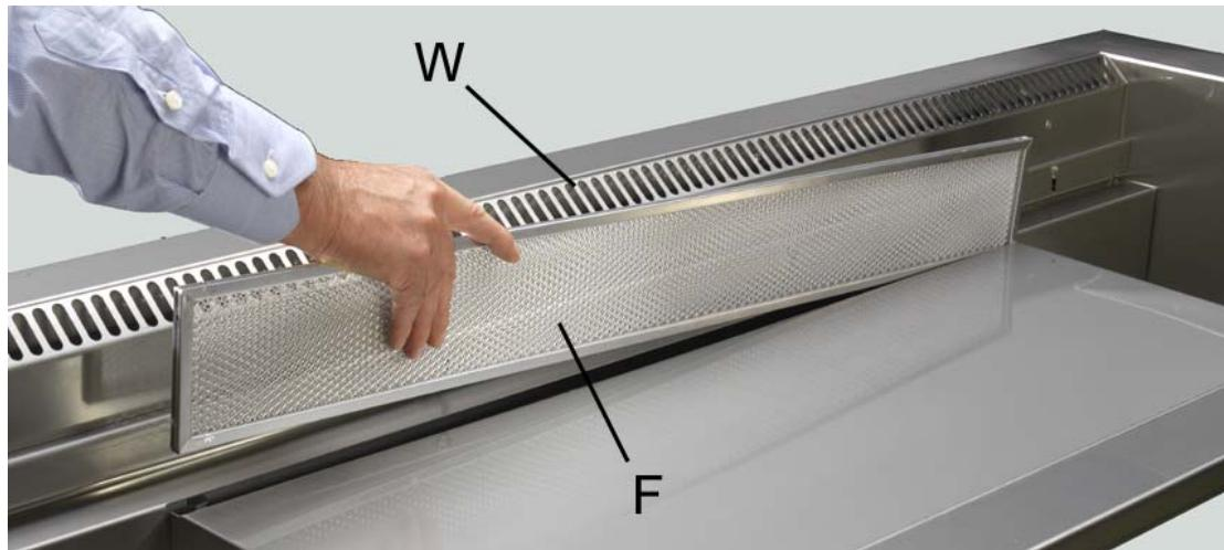
Los modelos ventilados incluyen también unos canales para la circulación del aire W que deben desmontarse y limpiarse periódicamente; esta operación es también útil para limpiar más a fondo todo el vano refrigerado.
