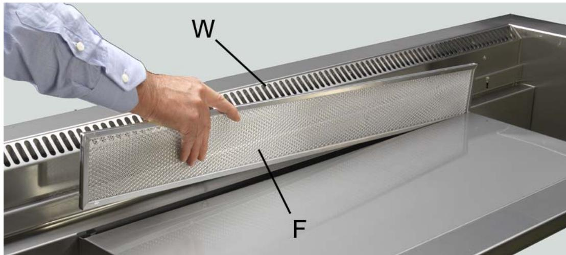
In de geventileerde modellen zijn ook luchtaanzuigers W aanwezig die periodiek verwijderd en schoongemaakt moeten worden. Deze reiniging is ook nuttig om de koelruimte grondiger schoon te maken.
