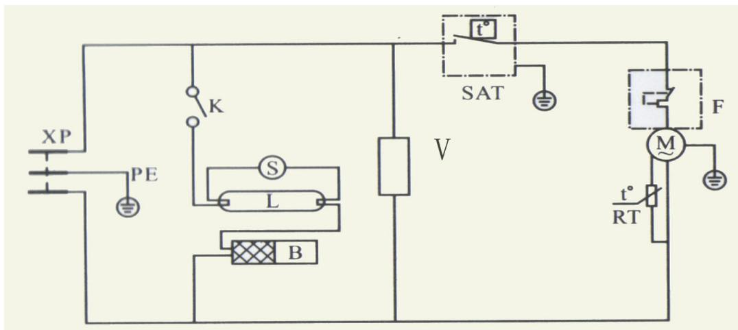
XP-Alimentation électrique M-Compresseur RT-Démarrage V-Turbine
