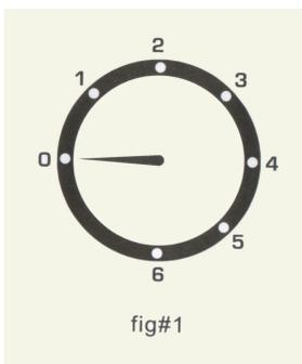
Die Innentemperatur reicht von 0 °C bis 10 °C. Sie können den Temperaturregler auf Ihre gewünschte Temperatur einstellen. Drehen Sie den Regler im Uhrzeigersinn, wobei die Innentemperatur sinkt. Es gibt 6 Einstellstufen. Wenn Sie den Regler auf 0 stellen, schalten Sie das Gerät dadurch aus.
