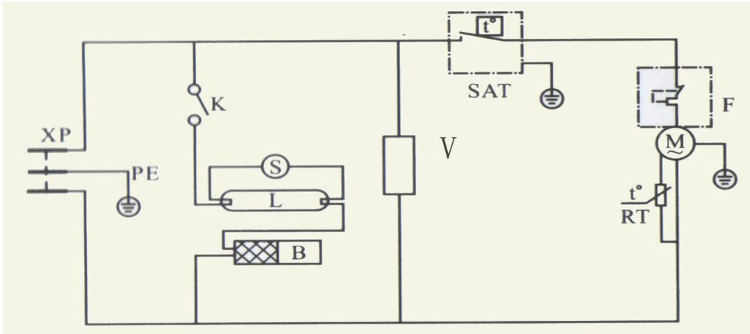
XP-Suministro de energía eléctrica M-Compresor RT-Arranque V-Ventilador
