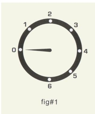
La temperatura interior varía desde 0° C a 10° C. Puede girar la manija del termostato para tener su temperatura deseada. Si gira la manija en sentido de las agujas del reloj, cuya posición varía de 1 a 6, puede obtener una temperatura inferior en el interior. Si gira la posición a 0, desactivará su dispositivo. Véase la ilustración 1 (*fig#1*).
