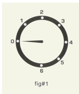
A temperatura interior varia entre os 0°C e os 10°C. A temperatura desejada poderá ser regulada no manípulo do termóstato. Rodando o manípulo no sentido horário, entre as posições 1 e 6, poderá reduzir a temperatura interna. Na posição 0 o aparelho estará desligado. Por favor consulte a figura #1.
