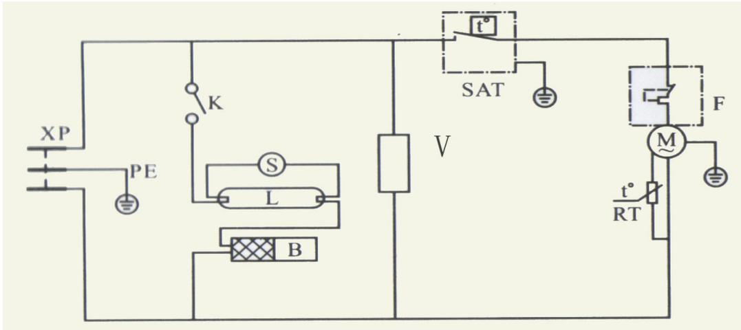
XP-Fonte de alimentação M-Compressor RT-Arranque V-Ventilador
