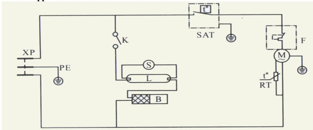
XP-Alimentation électrique M-Compresseur RT-Démarrage
