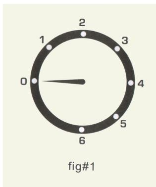
La température interne va de 0°C à 10°C. Vous pouvez régler le bouton du thermostat pour obtenir la température souhaitée. Faites tourner le bouton dans le sens des aiguilles d'une montre (les réglages vont de 1 à 6) pour obtenir une température plus froide à l'intérieur. Mettez-vous sur la position 0 pour éteindre votre appareil. Veuillez consulter la Figure 1.
