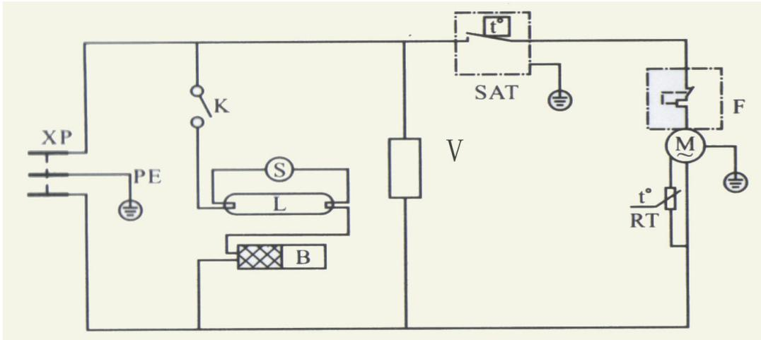
XP-Netzgerät    M-Kompressor    RT-Start    V-Lüfter
