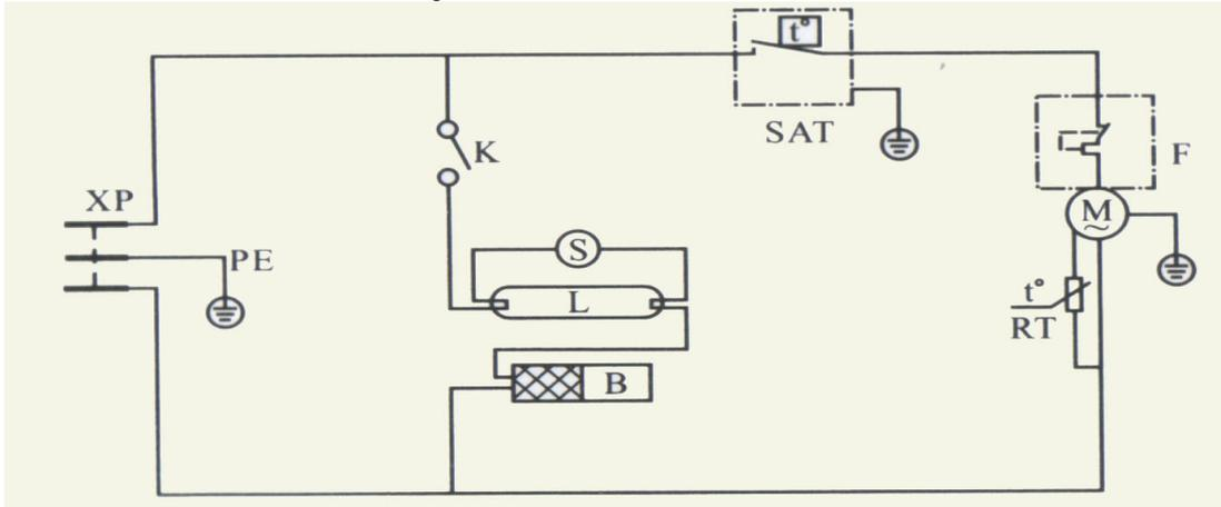
XP-Fonte de alimentação M-Compressor RT-Arranque V-Ventilador
