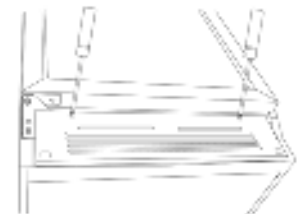
12. Bundpanelet monteres igen.
