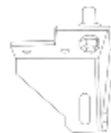
9. Verwijder de onderste scharnierpen en draai het onderscharnier 90 graden.
