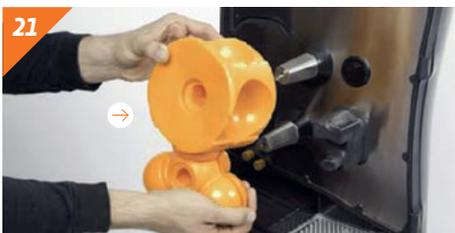
21 Stecken Sie die Presstrommeln paarweise auf.
