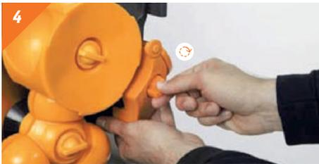
Entriegeln Sie das Messer indem Sie die Verriegelung um 180° drehen.
