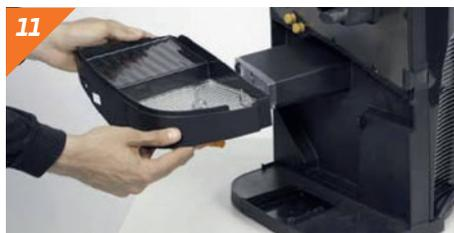
Entnehmen Sie den Auffangbehälter samt Filter und Zapfhahn.
