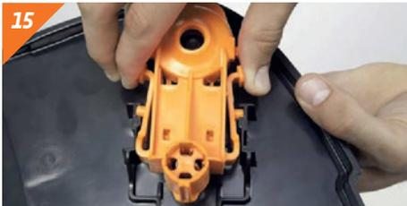
15 Setzen Sie den Zapfhahn ein indem Sie seitlich drücken und die Arretierstifte einrasten lassen.
