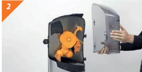
Öffnen Sie die Schutzhaube. Heben Sie die Schutzhaube nach oben ab.
