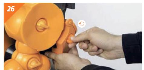
26 Verriegeln Sie die Arretierung mit einer 180° Drehung.
