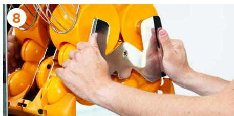
8 Heben Sie die **Entsaftereinheit 1Step** heraus, indem Sie sie an den Griffen aus rostfreiem Stahl zu sich heranziehen.
