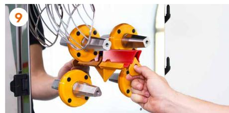
9 Setzen Sie den **Messerschutz auf** und ziehen Sie das **Messer am Griff** heraus.
