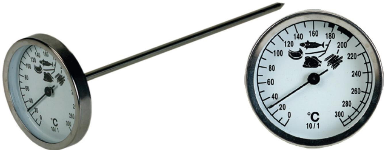
Das Thermometer dient zur Temperaturmessung der gebackenen Speisen. Gehäuse des Thermometers wurde aus rostfreiem Edelstahl 18/10 gefertigt. Durchmesser des Thermometerblattes: 50 mm.
