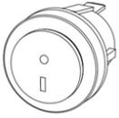
Mit der Taste am Heizstrahler wird das Gerät ein- und ausgeschaltet. Die Stellung „I“ bedeutet, dass das Gerät eingeschaltet ist, die erste Kontrollleuchte leuchtet rot auf und das Gerät ist betriebsbereit. Die Stellung „O“ bedeutet, dass das Gerät ausgeschaltet ist
