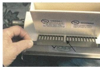
Die Kämme sind auf solch eine Weise aufzusetzen, dass sich zwischen den zwei längsten Kämmen die Plastiktrennwand befindet. Dieser Vorgang ist vor der Montage auf dem elektrischen Antriebsmotor durchzuführen.
