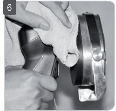
Vor dem Schärfen sollte das Messer immer gereinigt werden. Der Reinigungsprozess sollte auch nach jedem Schärfen des Messers durchgeführt werden.
