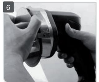
1. Man kann das Messer mit einem Schleifwerkzeug 1 bis 2 Sekunden schärfen, indem man es wie auf dem Bild einstellt.
