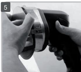
1. Die Schraube entfernen und den Verstellring abnehmen.
