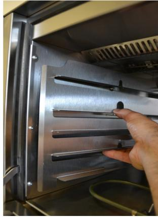
Zum Wiedereinbau der Schienen, legen Sie diese auf die 2 Metallstücke, üben leichten Druck aus und lassen Sie diese nach unten gleiten.
