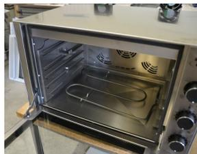
Der Einbau erfolgt in umgekehrter Reihenfolge. Achtung: Beachten Sie die Richtung des Widerstands.
