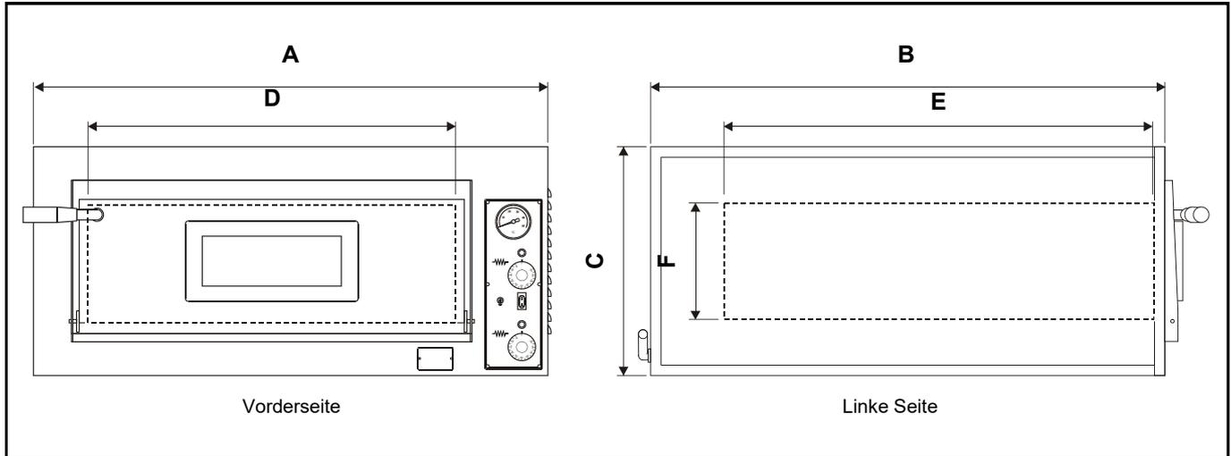
ABB. 3 (Abmessungen des Ofens und der Backkammer)
