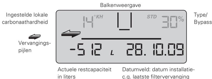
Als de maandlimiet een maand voor afloop van de ingestelde limiet bereikt is, wordt dit gesignaleerd door knipperen van het datumveld.
