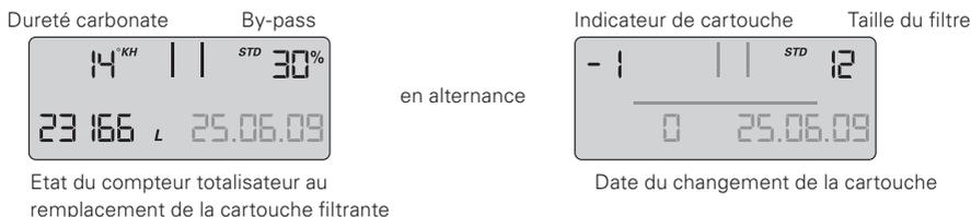
En haut à gauche se trouve l'indicateur de la cartouche filtrante (-1 pour l'avant-dernière cartouche) en alternance avec la dureté de l'eau réglée et en combinaison avec l'unité de dureté. En haut à droite se trouve la taille du système de filtration en alternance avec le réglage by-pass (représentation indicateur 1 s, dureté de l'eau 1 s), en bas à gauche l'état du compteur au remplacement de la cartouche (-1) et en bas à droite la date du changement de la cartouche.
