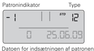
Til venstre foroven vises indikatoren for filterpatronen (-1 for den forudgående filterpatron) skiftevis med den derved indstillede på vandhårdhed sammen med med enheden for hårdheden. Øverst til højre vises filtersystemets størrelse skiftevis med forskæringsindstillingen (visning 1 sek. indikator, 1 sek. vandhårdhed), til venstre fornedes vises tællerstanden ved udskiftning af patronen (-1) og til højre fornedes datoen for indsætning af patronen.
