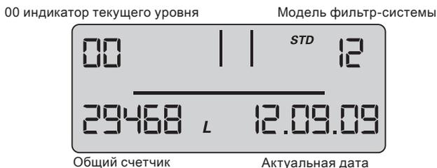
На этом уровне отображается общий счётчик, который подсчитывает весь объем очищенной воды, начиная от 0, независимо от числа замен картриджей.
