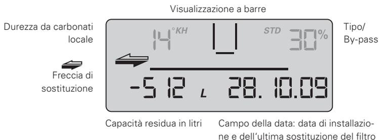
Se il limite mensile viene raggiunto un mese prima della scadenza del limite di tempo impostato, il campo della data lampeggia.
