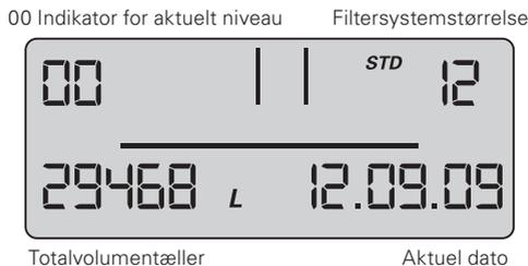
På dette niveau er der en totalvolumentæller, som tæller opad fra 0 uafhængigt af den aktuelle patronveksel.
