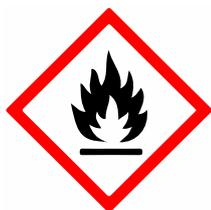
Im Gerät wurde das Kältemittel R600a eingesetzt – das natürliche, ökologische, leicht entzündbare Gas. Um den Kältekreislauf nicht zu beschädigen, ist beim Transport und bei der Inbetriebnahme des Geräts äußerste Vorsicht geboten.
