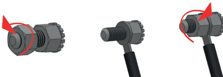
**Bild 7 Der Anschluss des Gerätes an die Einrichtung zum Potentialausgleich.**
