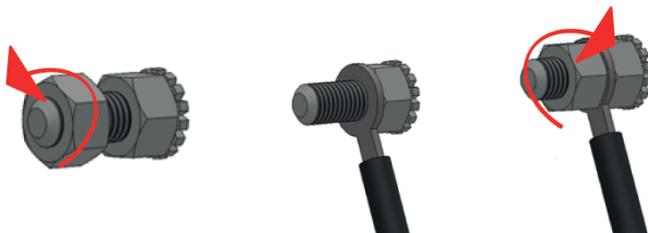
**Bild 3. Der Anschluss des Gerätes an die Einrichtung zum Potentialausgleich
