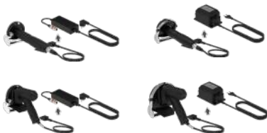
Kabel an Netzteil anschließen
